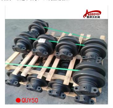
支重轮容易出现什么问题? (1) 轮体磨损。出现这种情况的原因是采用的钢材不合格或者说材料热处理时的硬度较低,耐磨性不足; (2) 漏油。支重轮轴通过轴套一直在旋转,轮体内要加油来润滑,但如果说密封圈不好的话,很容易产生漏油的现象,这样轴与轴套在无润滑的情况下,很容易磨损,造成产品无法进行使用。漏油原因有分以下几种: 1、浮动油封不合格; 2、产品轴套圆形度不够;、支轴光泽度不够; 4、齿轮油不达标; 5、加工尺寸公差等等。上述这些问题都会造成支重轮漏油的情况。福建中联QUY50支重轮售后厦门支重轮厂家联系电话。
